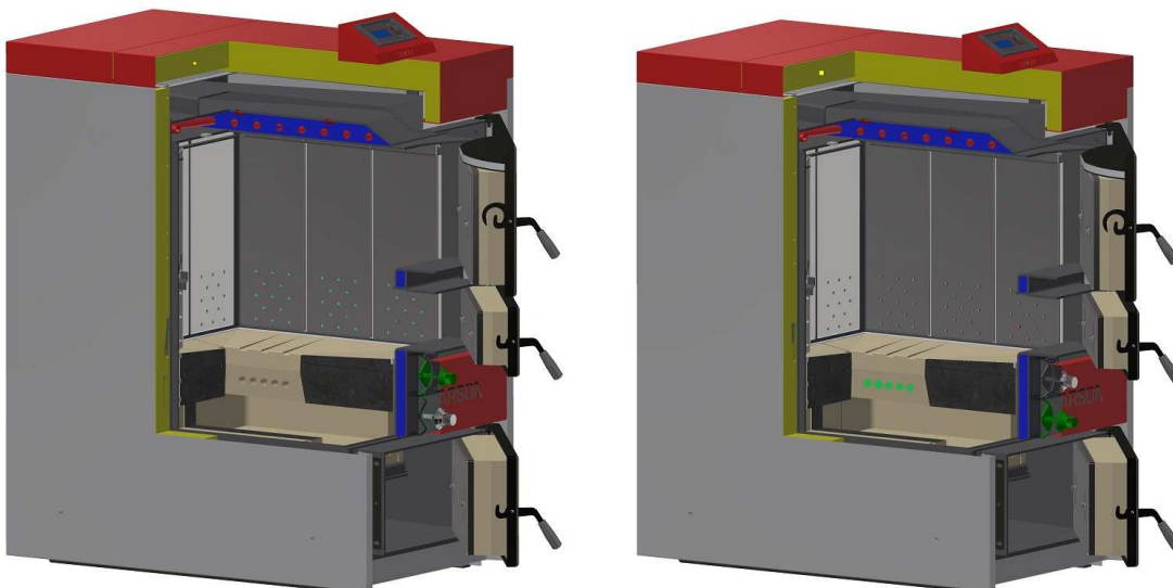
Obr. č. 28 – schéma vzduchových otvorů PRIMÁRNÍHO (vlevo) a SEKUNDÁRNÍHO (vpravo) vzduchu
