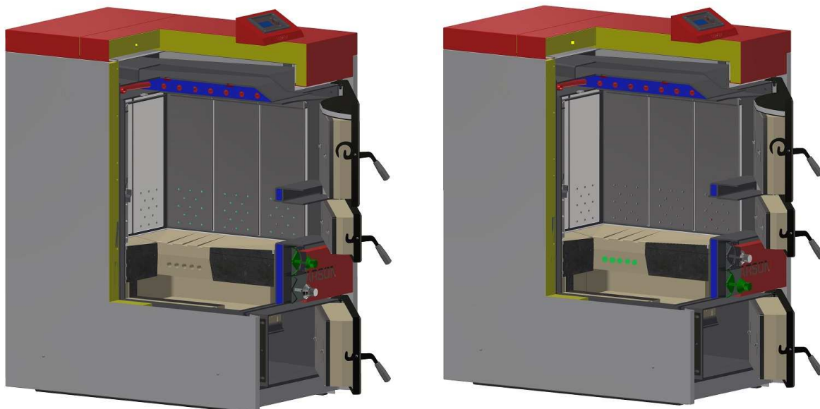
Obr. č. 23 – schéma vzduchových otvorů PRIMÁRNÍHO (vlevo) a SEKUNDÁRNÍHO (vpravo) vzduchu
